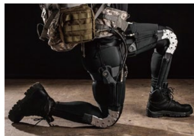
人間の能力を増幅する外骨格スーツ(DARPA)
